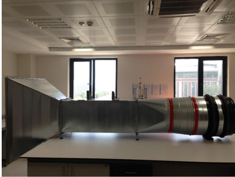
Şekil 2. İmal edilen rüzgar tünelinin gerçek görüntüsü.
