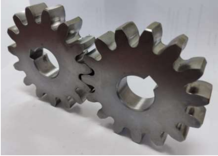
Şekil 3. eğri form konfigürasyonunun sahip eğri formulu dişli(Uzun et al., 2021),(Uzun & Inan, 2015).
