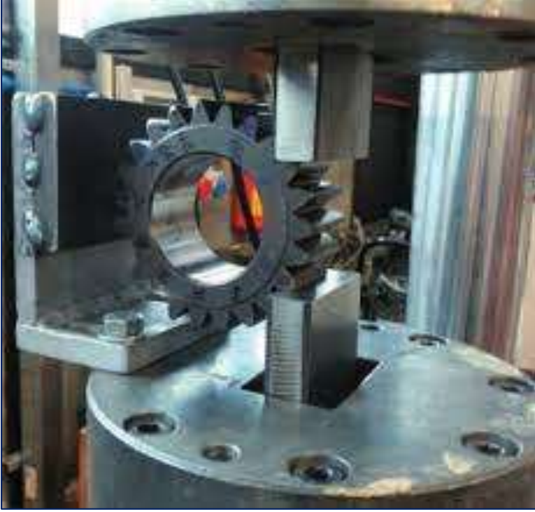
Şekil 4. Standart dişli, yük altındaki statik eğilme dayanım test cihazı(Meneghetti et al., 2017).
