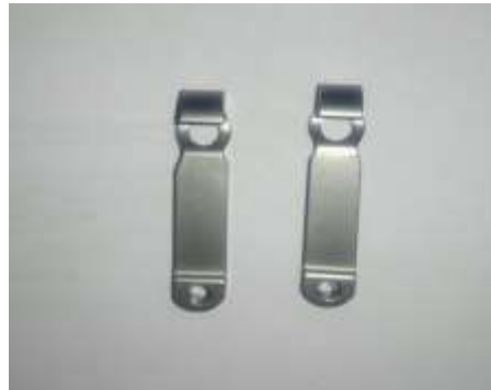
Şekil 6. 35 ve 60 s Kumlanmış Numune
