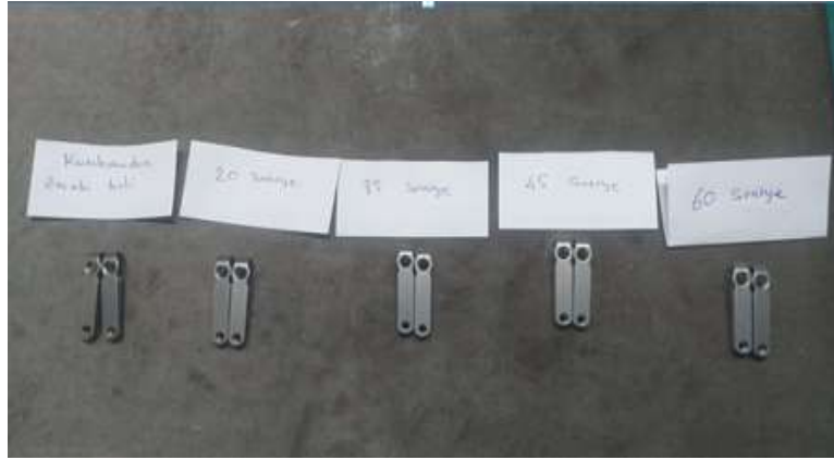
Şekil 5. Farklı Saniyelerde Kumlanmış Numuneler
