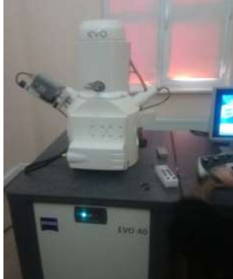
Şekil 7. SEM-EDX ZEISS EVO 40 Marka SEM Cihazı
