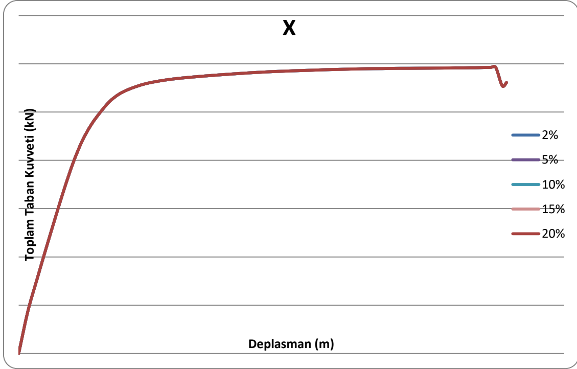
Şekil 4. X doğrultusunda elde edilen statik itme eğrilerinin karşılaştırılması
