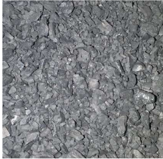
Şekil 7. 800 °C'de 1440 dk. karbonizasyon işlemine tabi tutulmuş badem kabukları
