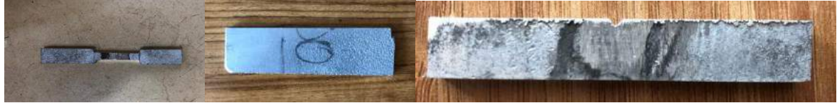
Şekil 3. Çekme, basma ve çentik darbe test numuneleri.
