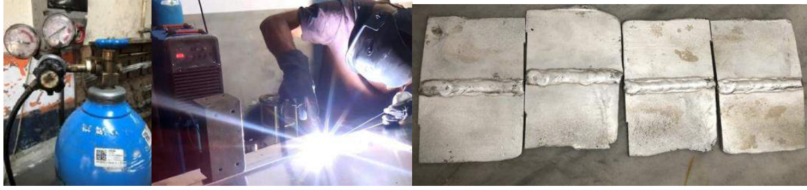
Şekil 2. TIG kaynağının uygulanması ve kaynatılmış plakalar.
