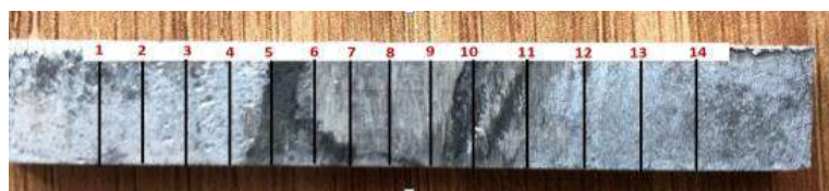
Şekil 8. Kaynaklı plakalarda kaynak bölgesi sertlik dağılımı.
