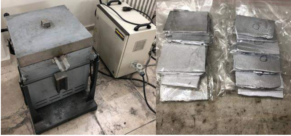
Şekil 1. Dökümde kullanılan ergitme fırını ve dökülmüş plakalar.
