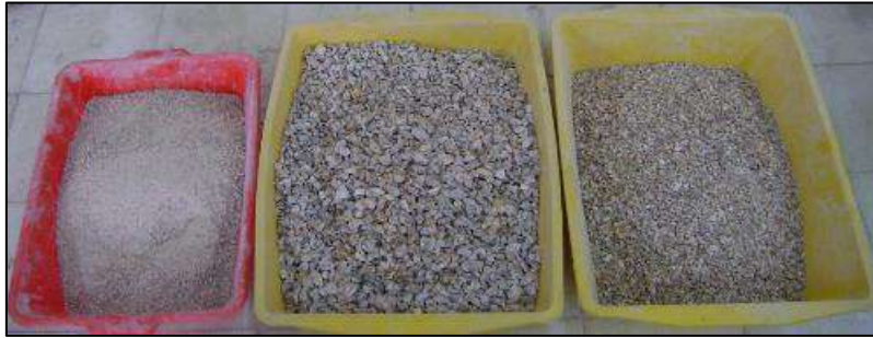
Şekil 5. Çeneli kırıcıda kırılmış sınıflarına ayrılmış barit agregası
