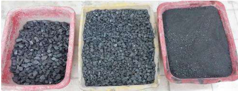
Şekil 3. Çeneli kırıcıda kırılmış sınıflarına ayrılmış manyetit kayacı
