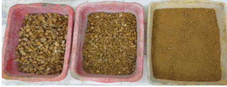
Şekil 4. Çeneli kırıcıda kırılmış sınıflarına ayrılmış limonit kayacı
